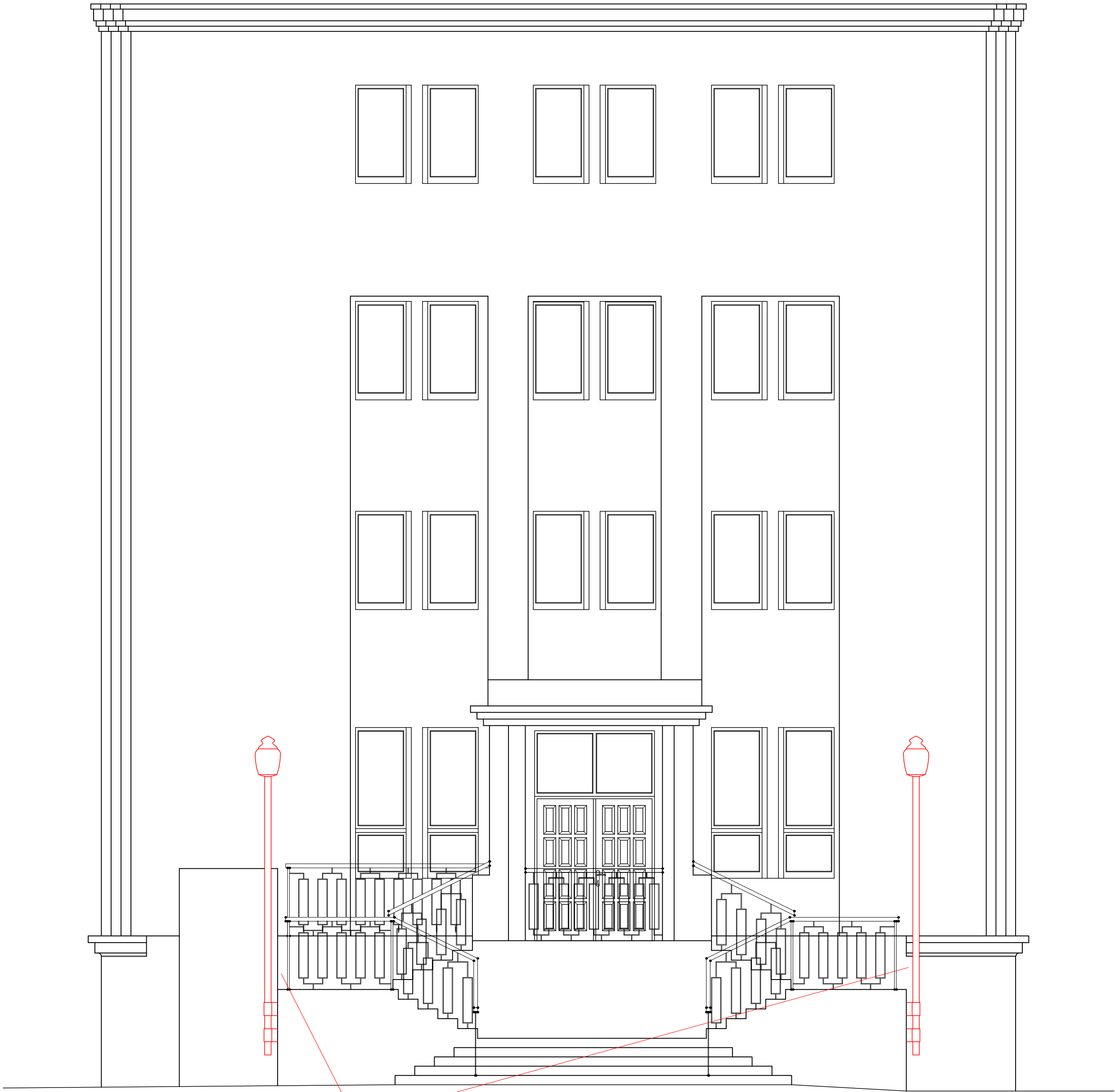
Kolumna KARIN 4800 LED 88 mocowana do ściany bocznej schodów
